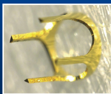
Au micromachined frame
